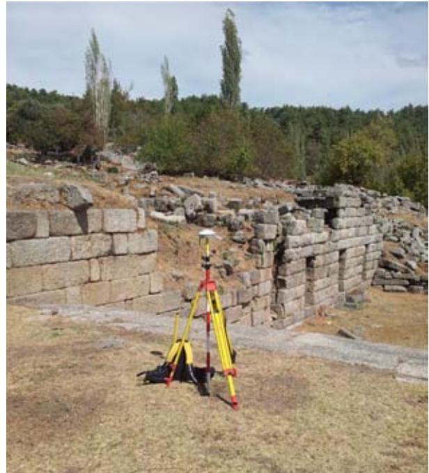
**Fig. 24 : Récepteur GPS bi-fréquences en station** (photo : P. Lebouteiller).
